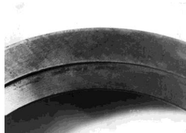
Рисунок 3 – Фотография контактной поверхности композиционного слоя, нанесенного на кольцо из стали мартенситного класса 30X13 через медную подложку
