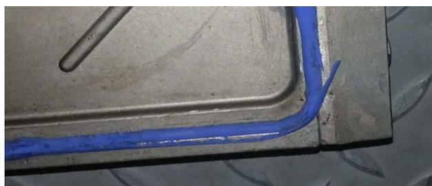
Рисунок 4 – Износ силиконового уплотнения на плите стерилизации фольги
