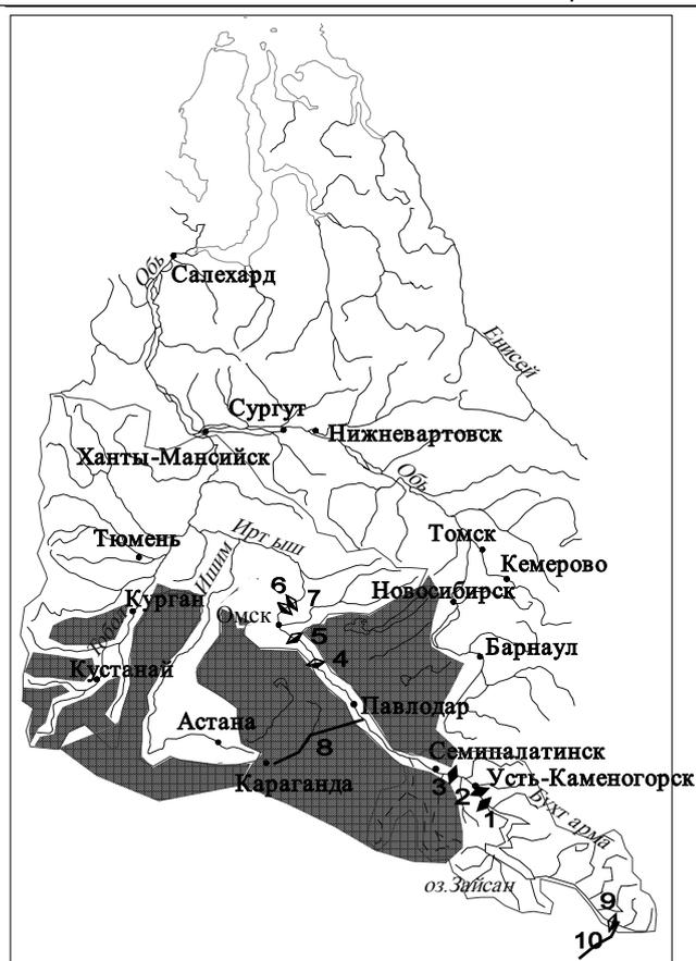
Рис. 1. Схема бессточных областей бассейна р. Иртыш (штриховка) и створов существующих, строящихся и проектируемых гидроузлов на Иртыше (ромбы)
