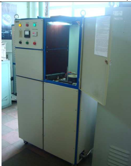
Рис. 2. Магнитно-импульсная установка для упрочняющей обработки дереворежущих ножей
