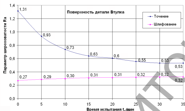
Рис. 2. Изменения параметра среднего арифметического отклонения профиля R_a поверхности детали втулка в процессе приработки
