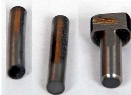
Рис. 2. Характер разрушения пуансонов
