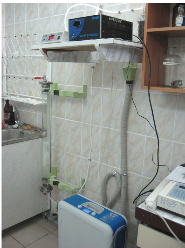
Рис. 1. Лабораторная установка на основе озонатора PLATON 10/2 для озонирования растворов
