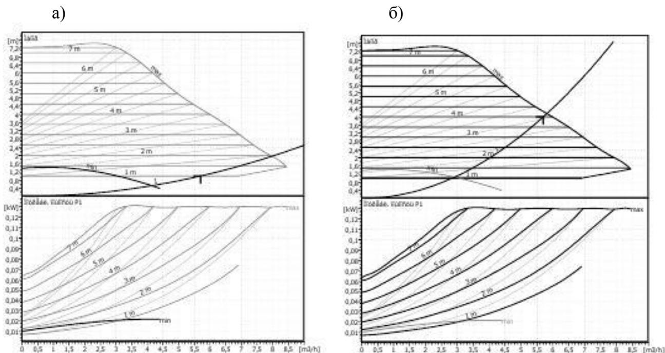
Рисунок 2 –Кривые насосов: а) при оптимальной скорости движения; б) при увеличенной скорости.
