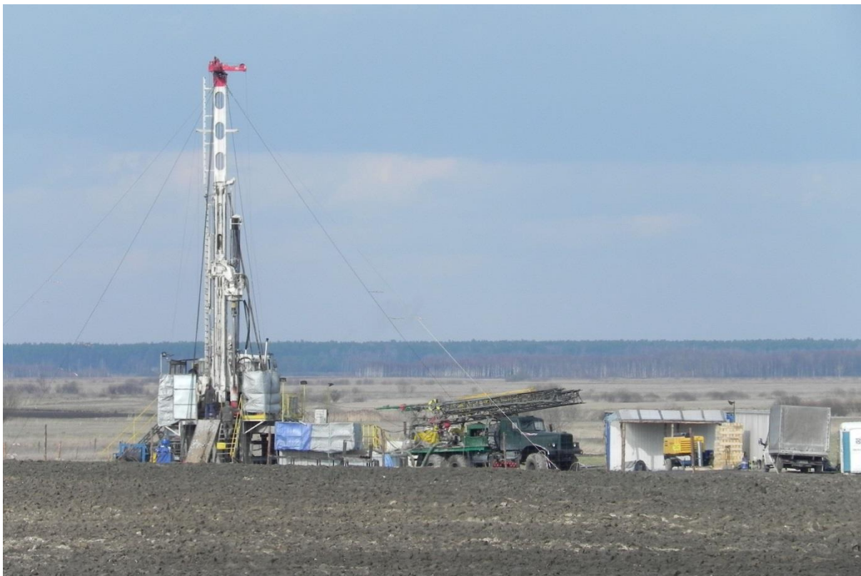
Fot. 21. Odwierty poszukiwawcze węgla kamiennego w okolicach Poleskiego Parku Narodowego (fot. G. Grzywaczewski)
