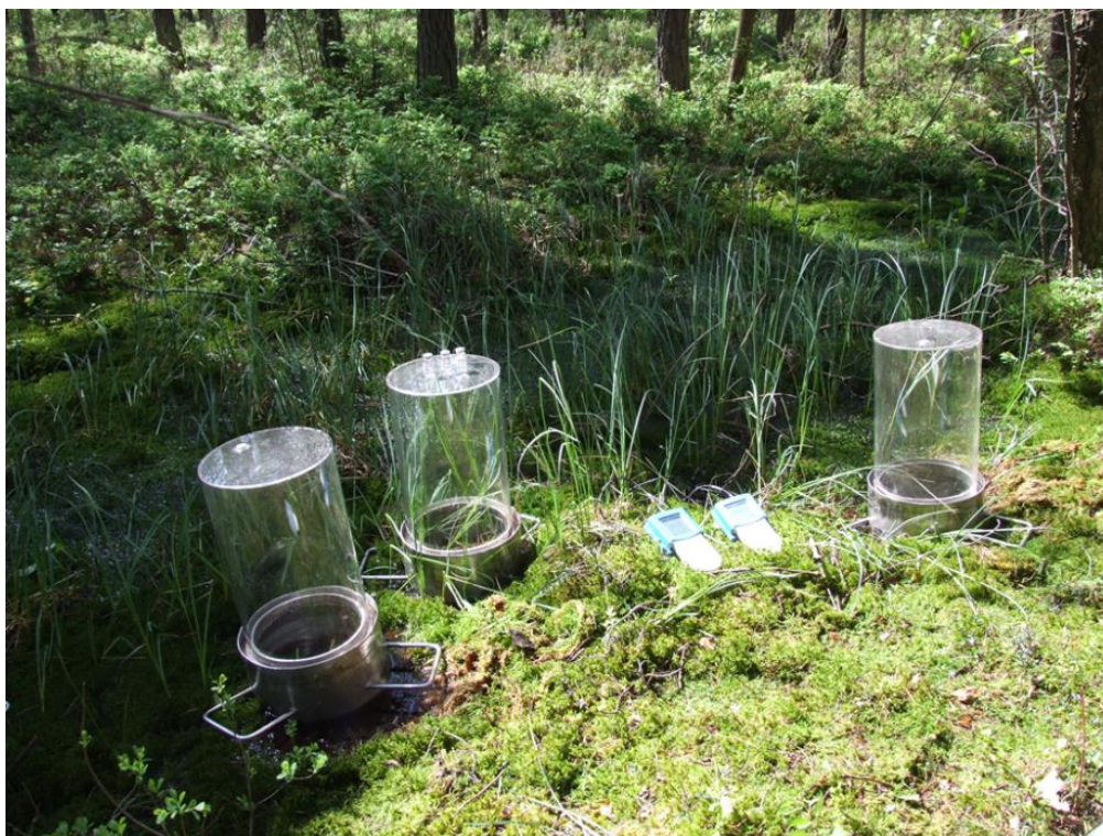
Fot. 1. Klosze stojące do gromadzenia gazów emitowanych z powierzchni torfowisk (fot. R. Bennicelli)
