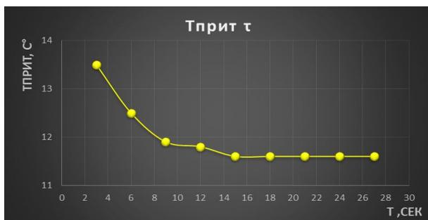
Рисунок 2 – График зависимости температуры приточного воздуха от времени проведения опыта
