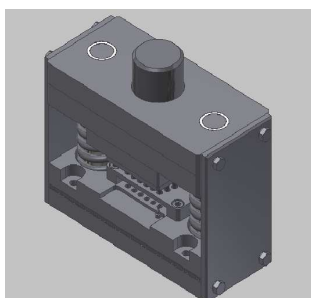
Рисунок 3. 3D-модель приспособления для пробивки отверстий в терке ANKLEPF
