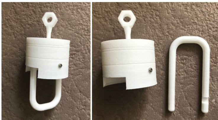
Рисунок 2. Модель замка навесного, выполненная на 3D принтере
