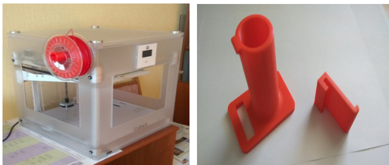
Рисунок 1. Крепление катушки для пластика
