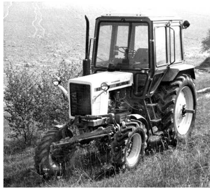
Рисунок 5. Трактор «Беларусь» с изменяемой геометрией ходовой системы для работы в условиях пересеченной и горной местности (во время испытаний на полигоне МТЗ, д. Абчак, Минский р-н)
