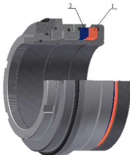
Рисунок 1 – 3D модель торцового уплотнения типа УТН-120
