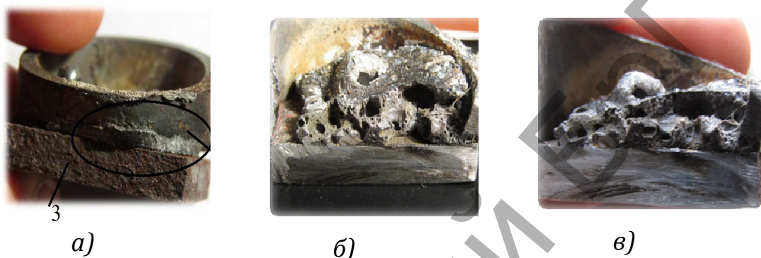
Рисунок 1 – конструкционные элементы сваренные данной экзотермической смесью (а) и в разрезе (б, в)
