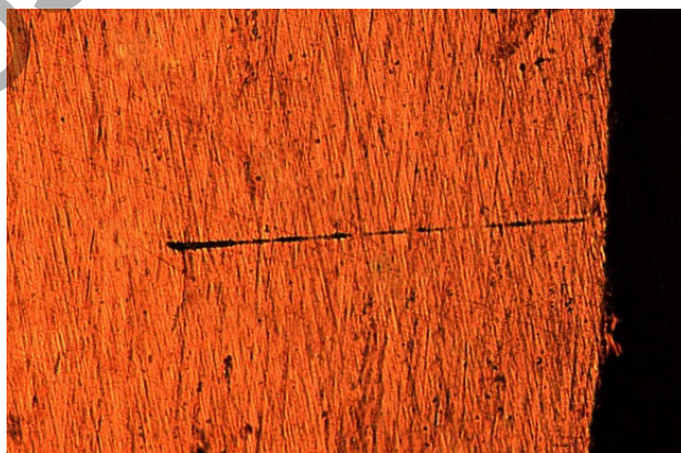
Рисунок 1 – Микроструктура стали с сформировавшейся канальной зоной от прошивки сгустком порошковых частиц (активация поверхности), \times 800
