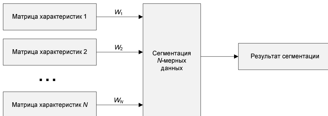
Рис. 6. Схема алгоритма совместной сегментации ( W_i – весовой коэффициент)
