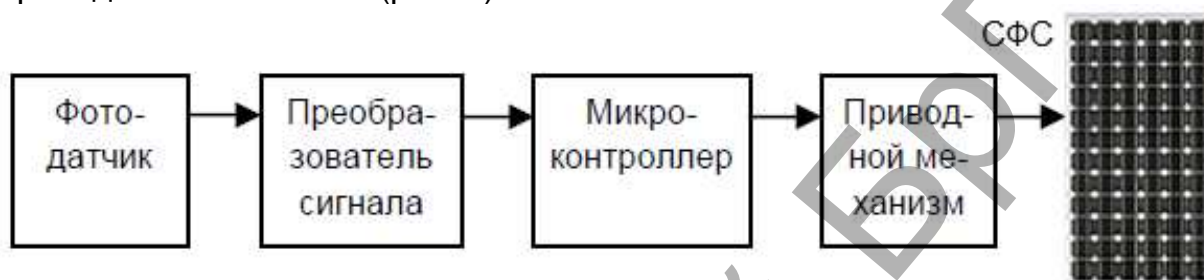
Рисунок 4 - Структурная схема системы отслеживания за Солнцем
