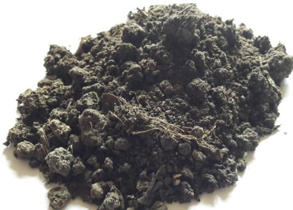
Рисунок 2 – Продукт из осадка сточных вод после процесса компостирования
