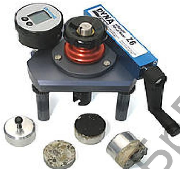
**Рисунок II.13 – Прибор ПОС 30-МГ4 и анкерные диски для определения прочности методом отрыва [7]**
