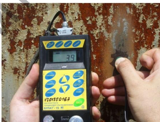
**Рисунок IV.1 – Измерение толщины металла ультразвуковым толщиномером**
