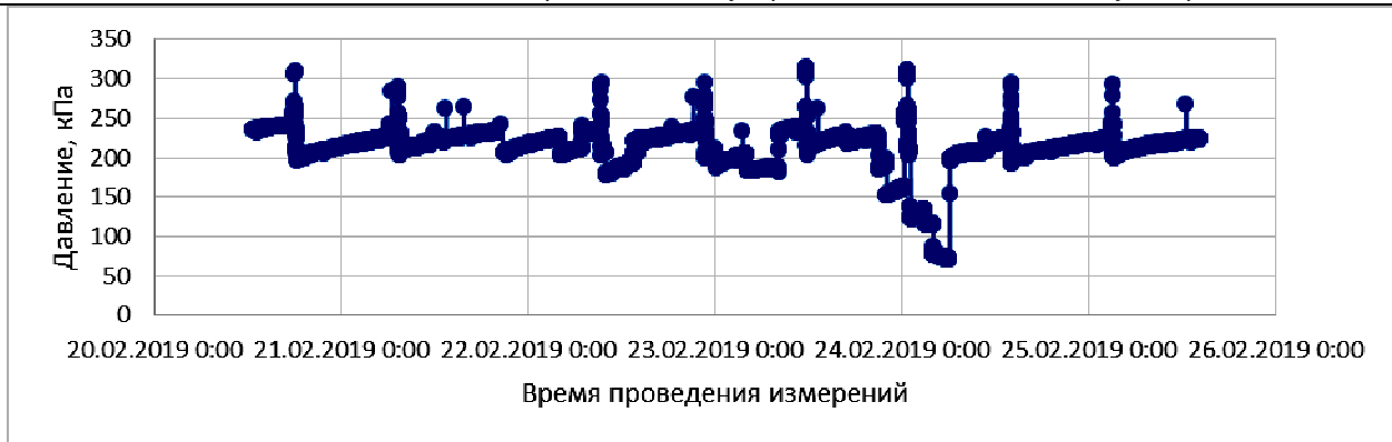
Рисунок 1 – График изменения давления на оголовке водозаборной скважины, подключенной к системе сборных водоводов
