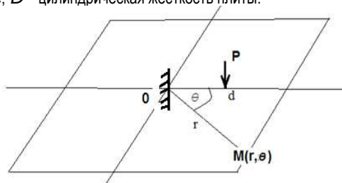
Рисунок 4 – Плита с защемленной нормалью в полярных координатах
