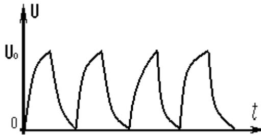
Рис. 9. Процесс заряда/разряда конденсатора, если на вход RC – цепи подавать импульсное напряжение
