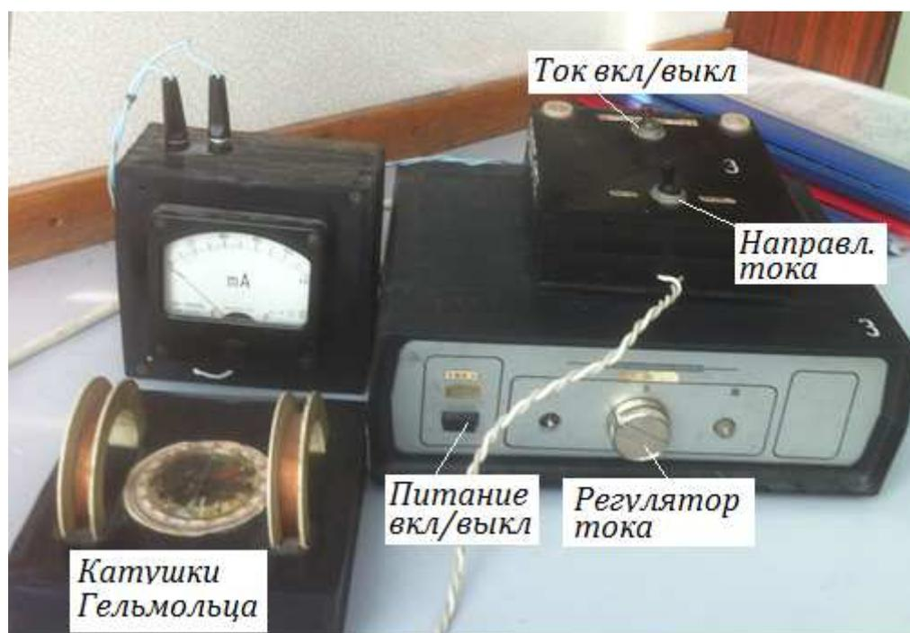
Рис. 2. Лабораторный стенд для определения индукции горизонтальной составляющей магнитного поля Земли.
