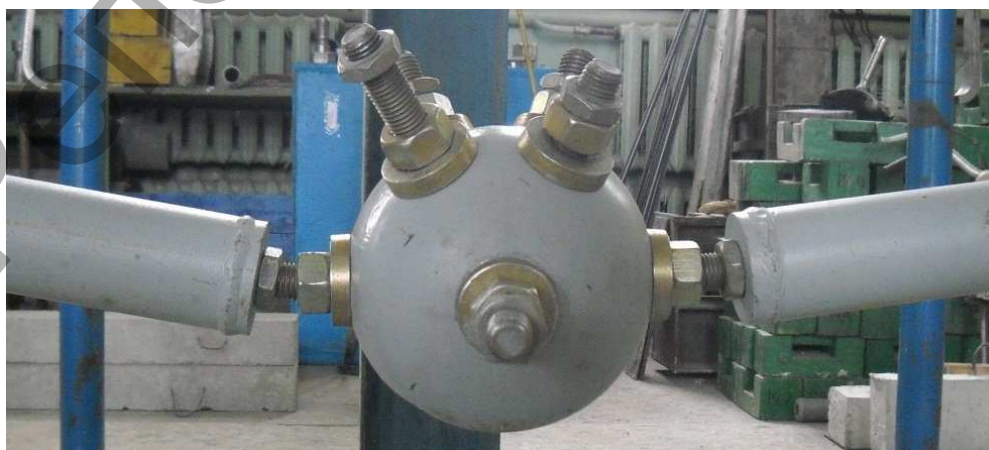
Рис. 5. Узловой элемент 160-M20 после полной разгрузки фрагмента
