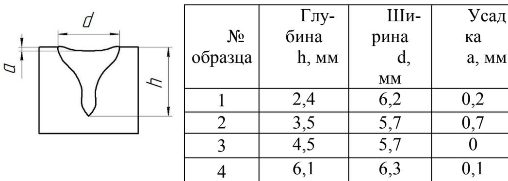
Рисунок 2 – Геометрические параметры сварных швов образцов
