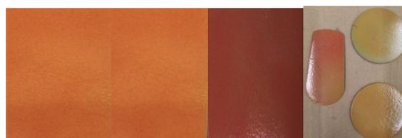
Рисунок 2 – Изменение цвета покрытия в зависимости от режимов напыления
