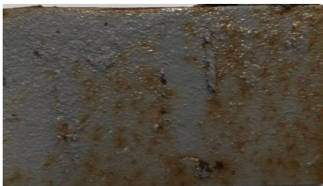
Рисунок 3 – Покрытия, нанесенные на неподготовленную поверхность
