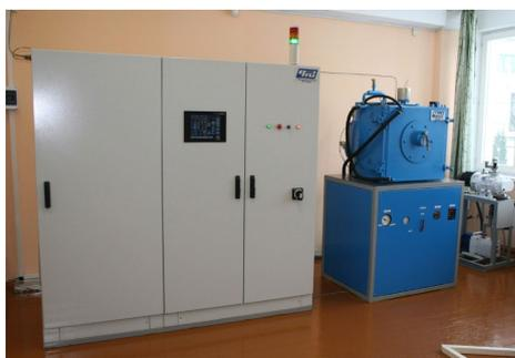
Рисунок 1 – Установка ионного азотирования
