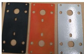
Рисунок 1 – Напыленные полимерные покрытия из различных материалов
