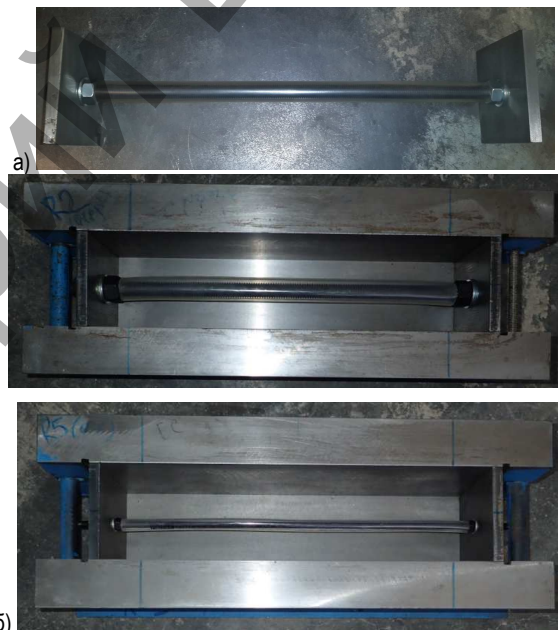
Рис. 9. Общий вид армирующего элемента опытных образцов (а) и форм для изготовления призм с установленным по месту армирующим элементом (б)
