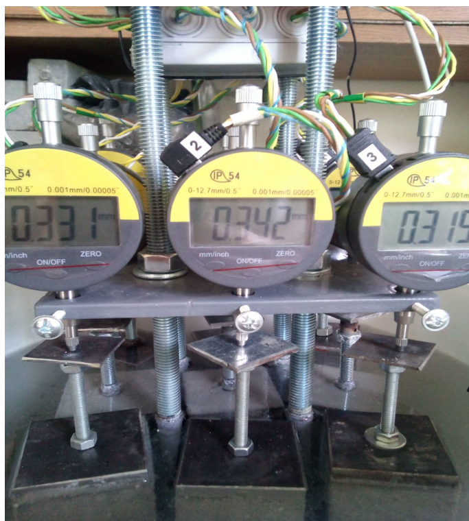
Рисунок 4 – Вид изготовленной и апробированной установки для контроля деформаций усадки и ползучести
