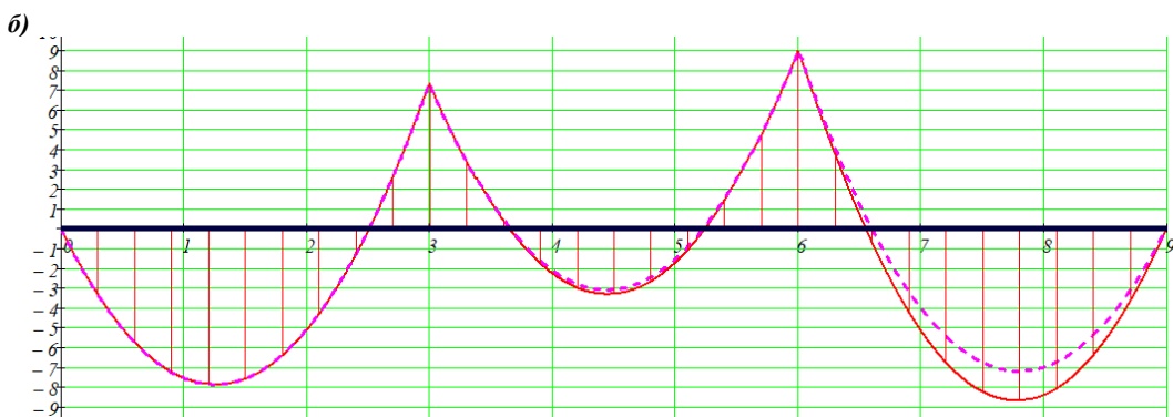
EI_1=674.61 \text{ кНм}^2 , EA_1=453.2 \text{ МН} ; EI_2=0.522 \text{ кНм}^2 , EA_2=37.11 \text{ МН} ; EI_3=0.087 \text{ кНм}^2 , EA_3=6.185 \text{ МН} . Эпюры изгибающих моментов в балке: а) без преднапряжения; б) с предварительным напряжением в стержнях 4 ( P_n = 90 \text{ кН} ) и 5 ( P_n = 55 \text{ кН} ) Рисунок 3 – Расчетная схема комбинированной балочно-вантовой системы
