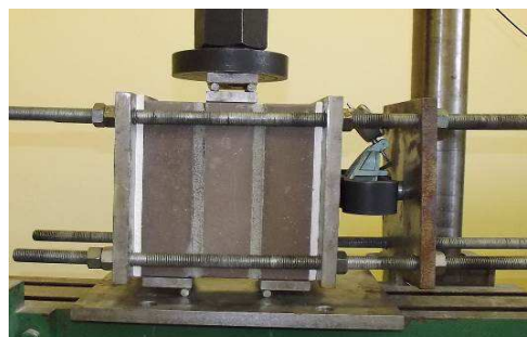
1 – испытываемый образец кладки, 2 – динамометр для контроля уровня обжатия, 3 – передаточные пластины для передачи обжатия, 4 – пластины с роликовыми опорами, 5 – гипсовая прокладка
