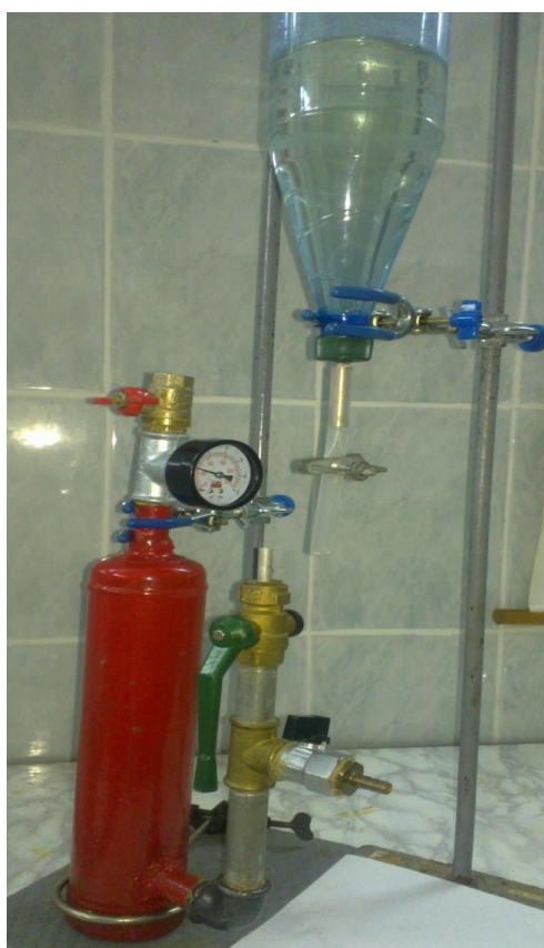
Рисунок 3. Лабораторная установка по очистке цветных маломутных вод Республики Беларусь методом напорной реагентной флотации для предприятий энергетики
