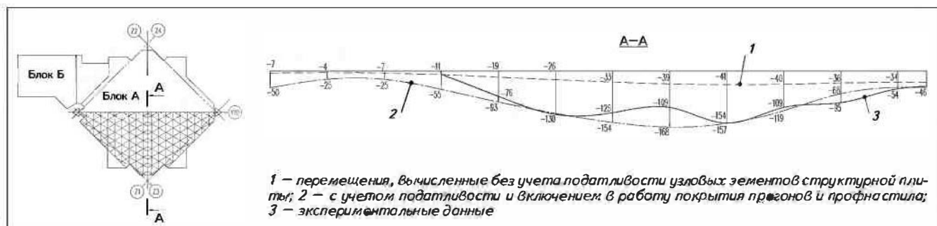
Рис. 6. Эпюры вертикальных перемещений верхних узлов структурной плиты
