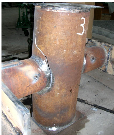
Рис. 1. Общий вид стенда для испытаний крестообразных соединений из труб (а) и доведенный до разрушения крестообразный стык труб (б)
