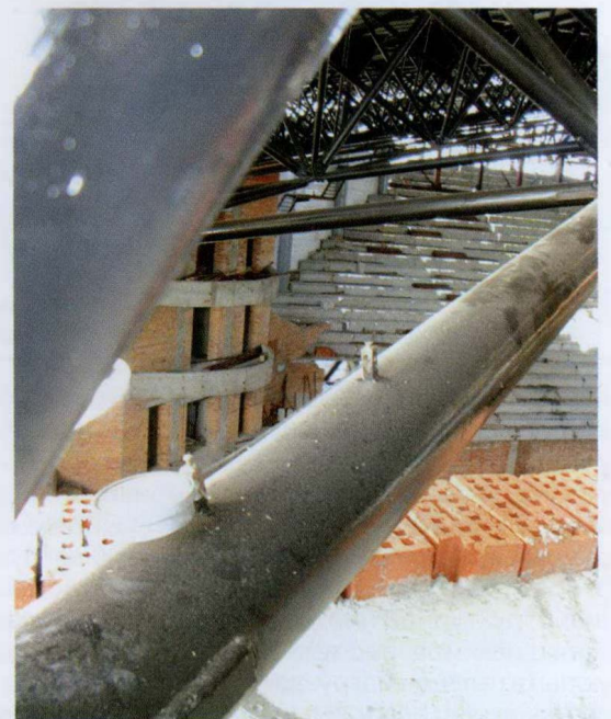
Рис. 6. Измерение усилий в подвесках (а), в нижнем поясе арки (б) и стержне структуры (в)
