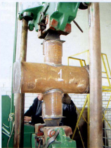
Рис. 4. Испытание узла крепления подвески к затяжке
