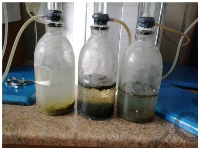
Рисунок 4 – Реакторы с продуктами сбраживания хвои сосны
