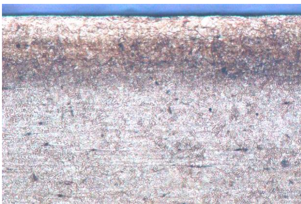
Рисунок 6 – Микроструктура сталей 38X2МЮА (а, \times 100 ) и 40X (б), подвергнутых ИА
