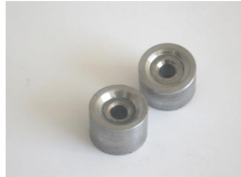
Рисунок 5 – Сборные твердосплавные фильеры, изготовленные по усовершенствованной технологии электроконтактного спекания рабочих элементов
