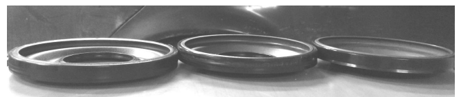
Рисунок 1 – Поршни муфты усиления первой передачи с различной деформацией
