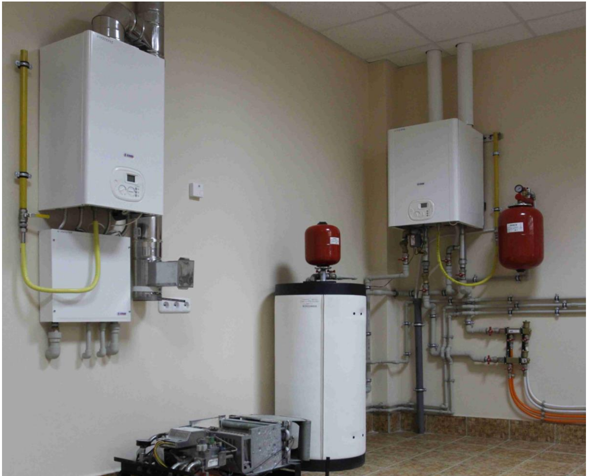
Рисунок 5 – Стенд лаборатории теплогенерирующих установок и энергосбережения с газовыми котлами
