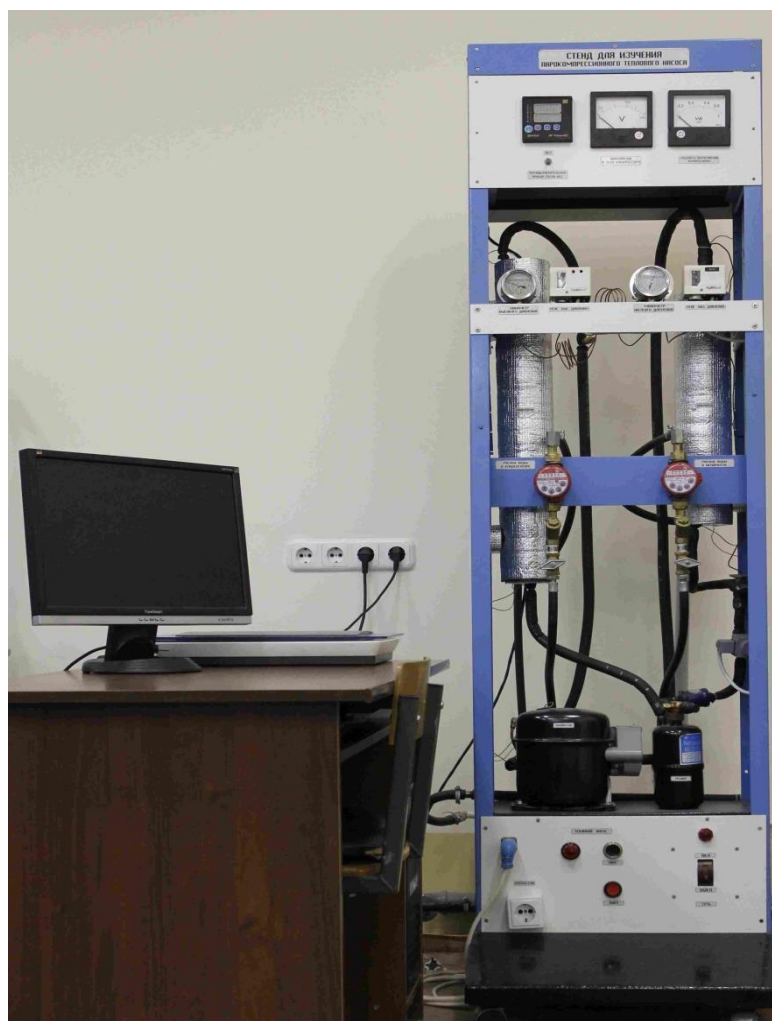
Рисунок 10 – Стенд «Тепловой насос»
