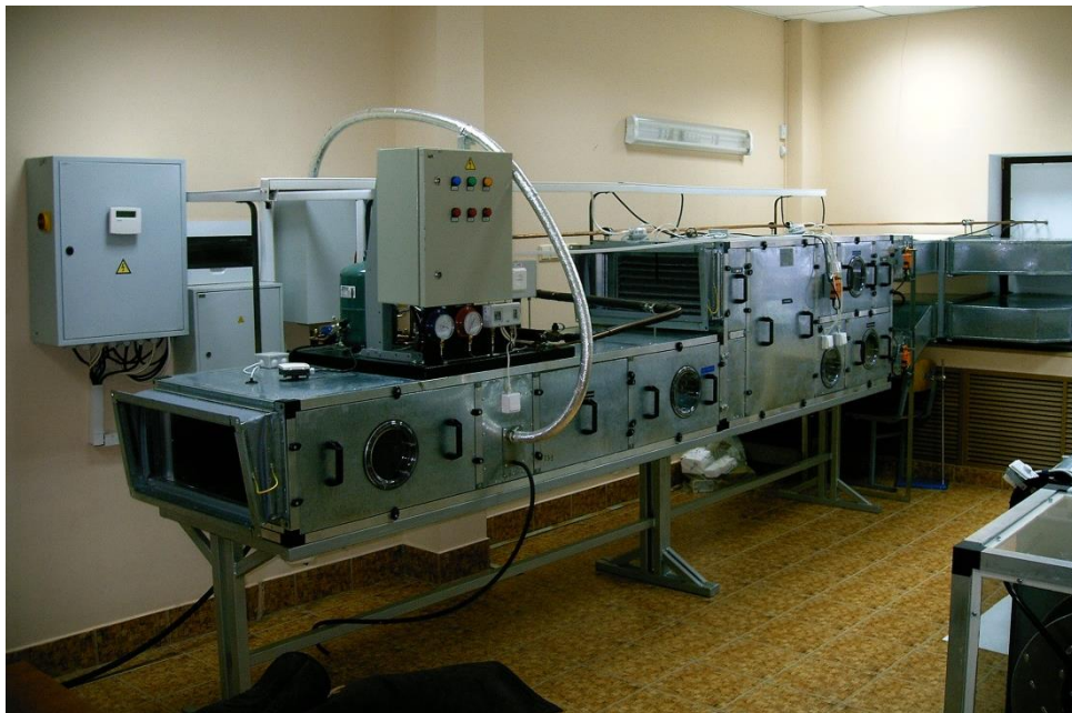
Рисунок 9 – Стенд “Центральный промышленный кондиционер”
