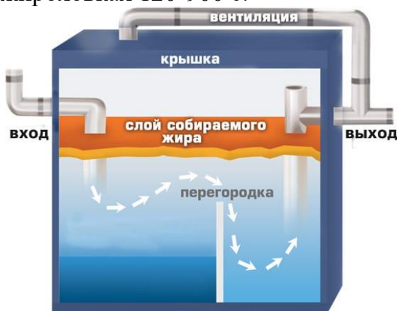
Схема очистки сточных вод после автомойки
