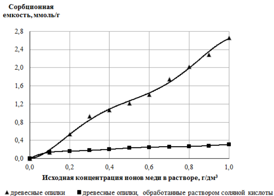
Рисунок 1 — Изотермы сорбции ионов меди
