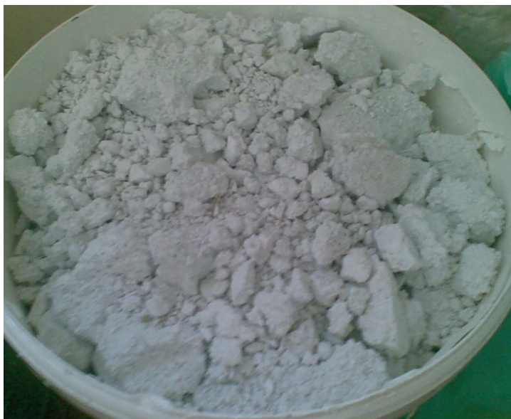
Rycina 1.2 Odpady z oczyszczania wody, utworzone w zbiornikach ściekowych, powstałe podczas procesu szlifowania i polerowania szkła, wykorzystywane przy produkcji próbek
