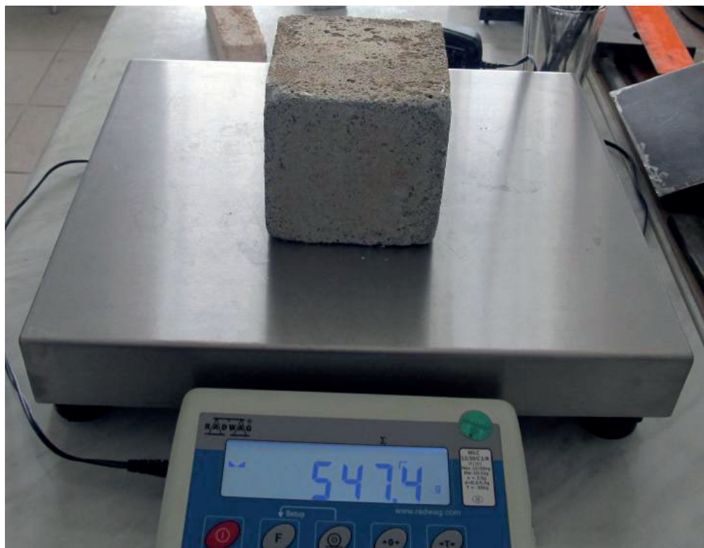
Rycina 1.14 Ważenie próbek z dokładnością do 0,1 grama
