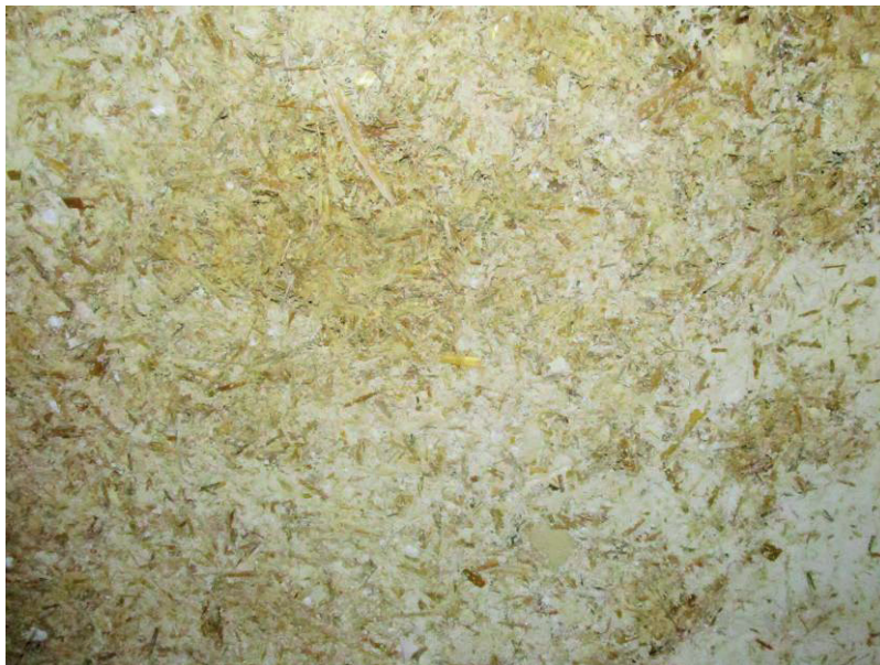
Rycina 1.7 Powierzchnia próbki serii FRG-2LS o gęstości w formie suchej 600-700 kg/m 3
