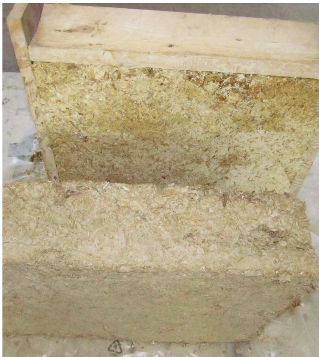
Rycina 1.5 Próbkę FRG-2LS, przygotowane w drewnianej konstrukcji
