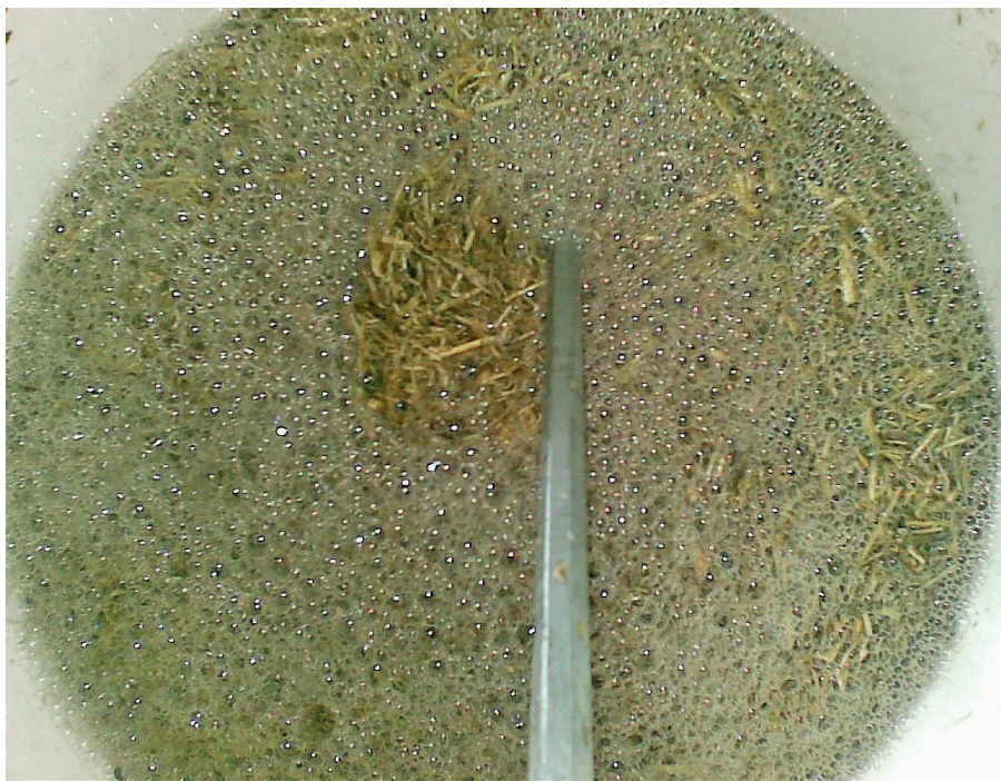
Rycina 1.1 Płukanie paździerzy lnu przed mineralizacją
