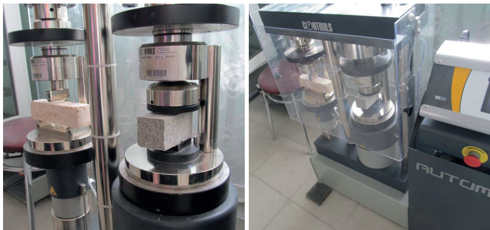
Rycina 1.12 Określenie wytrzymałości na zginanie i kompresji na próbkach belkowych
