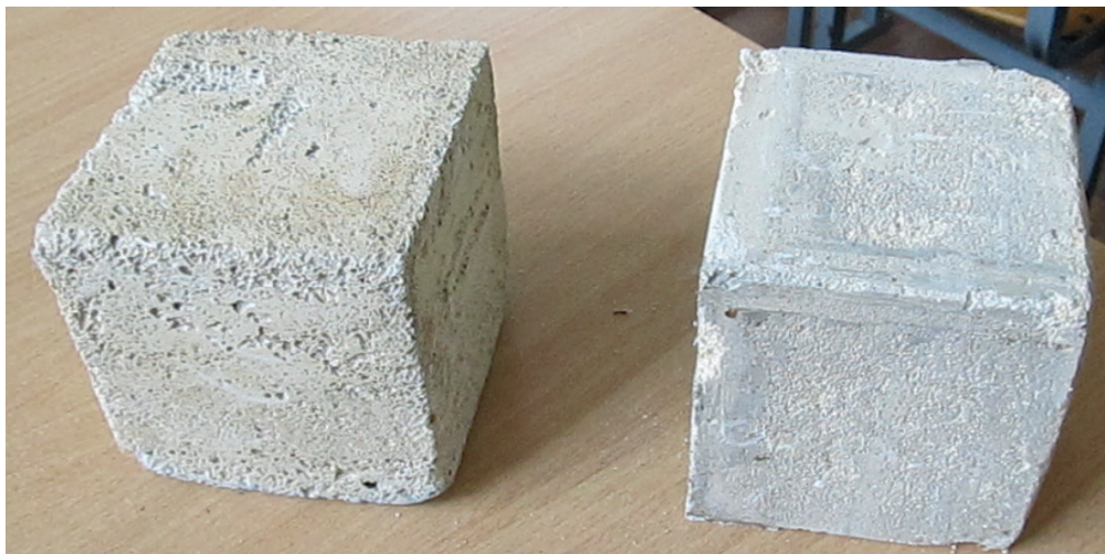
Rycina 1.8 Próbkę serii FRA-3CLS (nieautoklawizowany wapienno-krzemionkowy gazofibrobeton ze spoiwem mieszanym)
