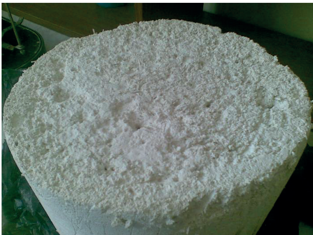
Rycina 1.9 Próbkę serii FRA-4LS (nieautoklawizowany wapienno-krzemionkowy gazofibrobeton ze spoiwem wapiennym)
