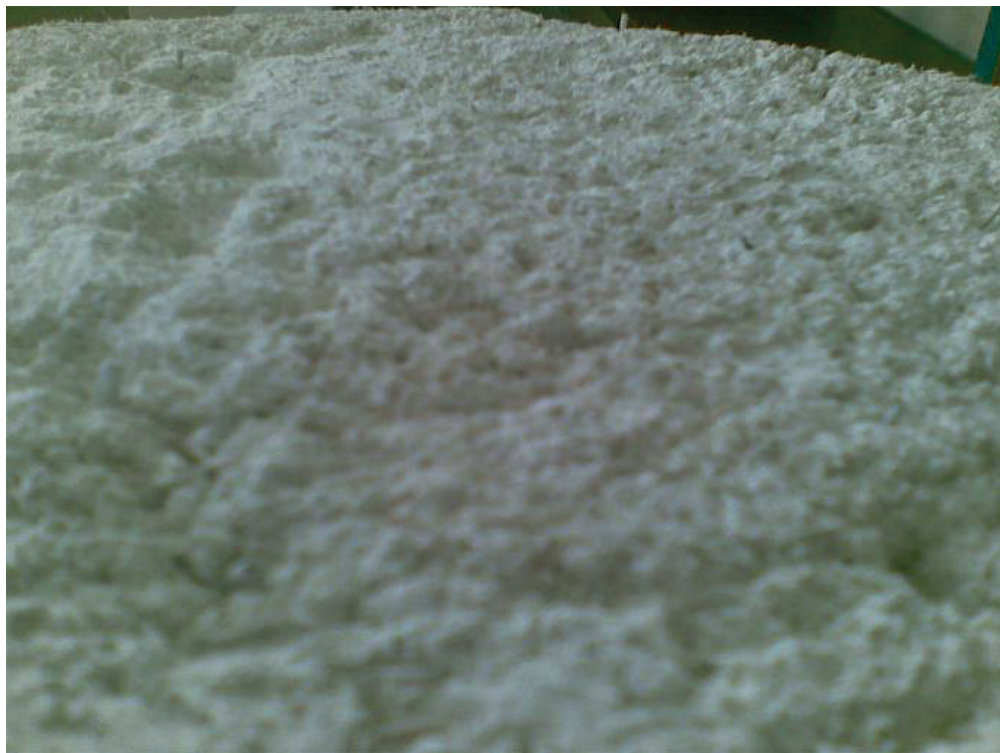
Rycina 1.10 Powierzchnia próbki serii FRA-4LS (nieautoklawizowany wapienno-krzemionkowy gazofibrobeton ze spoiwem wapiennym)
