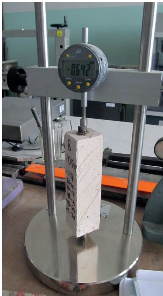
Rycina 1.15 Określenie deformacji skurczowych spoiw
