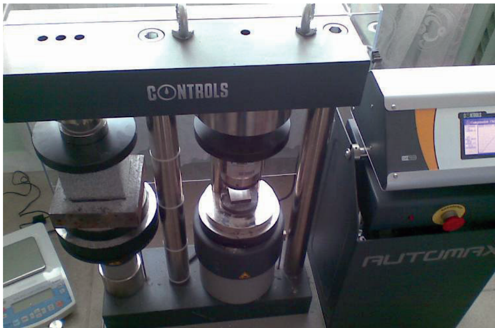
Rycina 1.11 Badanie sprężenia na próbkach – bryłach o długości żebra 100 mm
