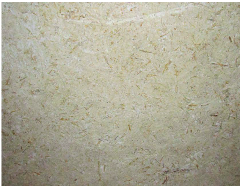
Rycina 1.6 Powierzchnia próbki serii FRG-2LS o gęstości w stanie suchym 800-900 kg/m 3
