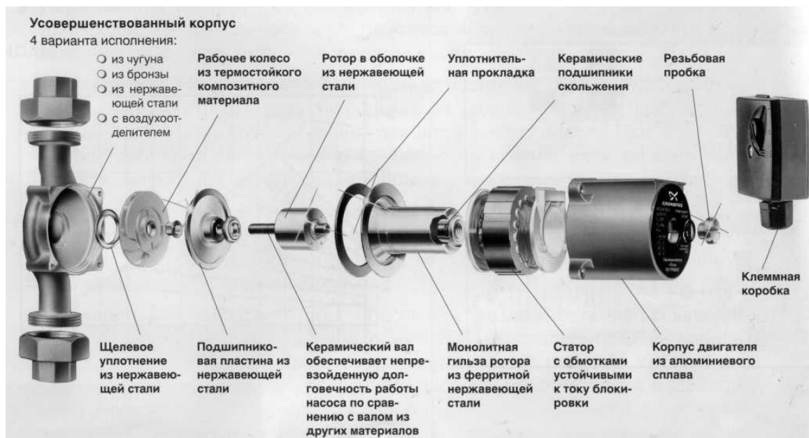
Рис. 2.5 Устройство насоса UPS с мокрым ротором
