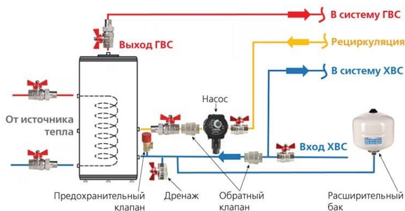
Рисунок 6.3 – Схема обвязки бойлера косвенного нагрева с расширительным баком на В1
