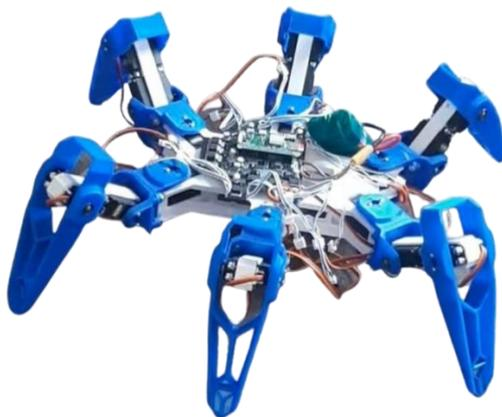
Рисунок 1 – Робот-муравей в собранном состоянии
