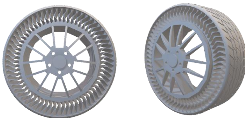
Рисунок 2 - Прототип 3d модели безвоздушных шин
