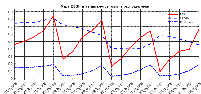
Рисунок 3 – Графики MOS и параметров гамма-распределения для меры BEGH, тип искажения – импульсный шум (коэффициент корреляция Спирмена для MOS и количественных оценок – меньше 0,7)
