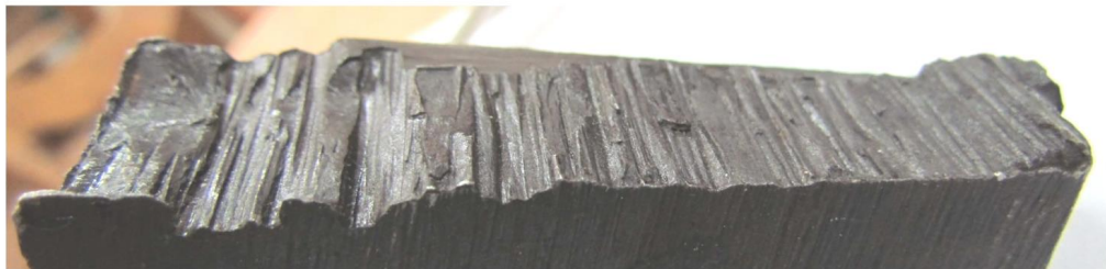
Рисунок 2 – Неизотропный характер поверхности излома
