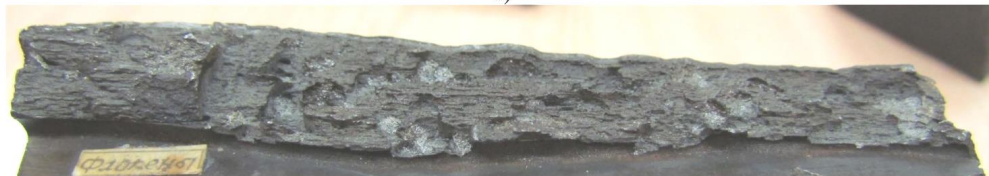
Рисунок 1 – Неоднородный характер поверхности излома
