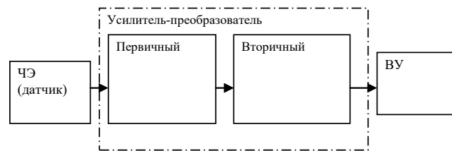
Рис. 1. Общая структурная схема детекторов транспорта
