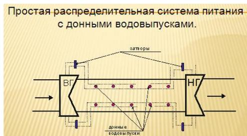
Такой подход к выбору системы питания объясняется необходимостью сокращения продолжительности наполнения камеры и обеспечением устойчивого водного режима в нижнем бьефе (при больших выходных скоростях из водоводов, суда не смогут пришвартоваться и подойти к НГ камеры).
