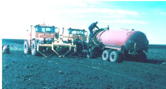
Рис. 3. Движение автоматизированного комплекса внутрипочвенного внесения животноводческих стоков
