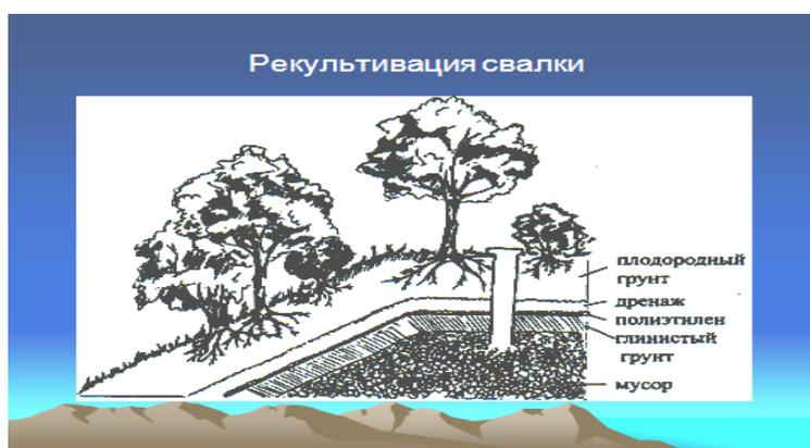
Рис. 1. Рекультивация твердых бытовых отходов
