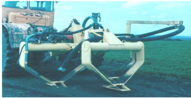
Рис. 2. Устройство для глубокого объемного разуплотнения почвы и внесения животноводческих стоков и жидких мелиорантов (РГ-0,5М)
