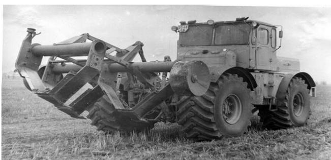
Рис. 1. Трехстоечный рыхлитель РГ-0,5
