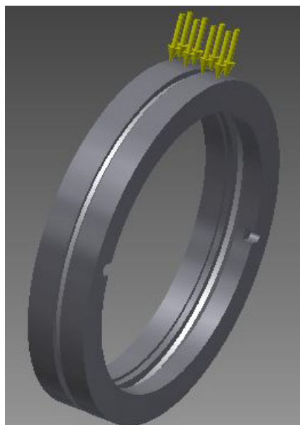
Рисунок 2 – Приложенная нагрузка в 3D модели контактных колец
