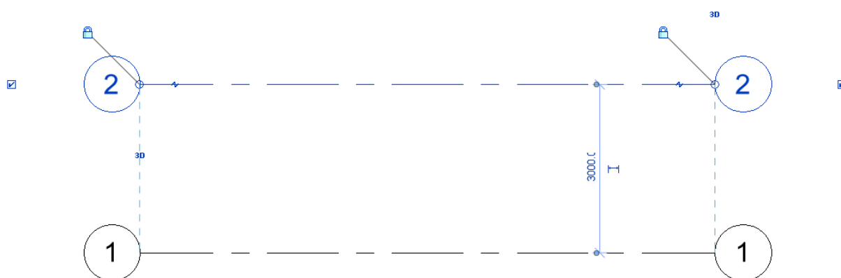
Рис. 3.11. Элементы оси, контролирующие взаиморасположение
