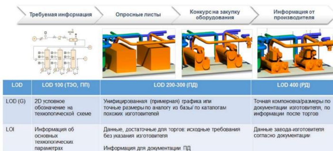
Рис. 1.6 Уровни проработки для технологического оборудования
